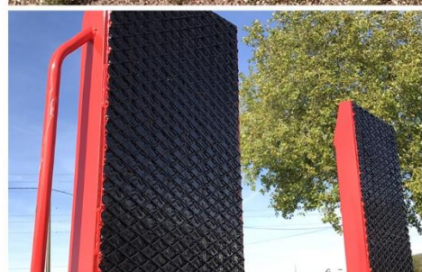
Dim. : 4m00 x 2m04, RC 285/70 R19.5, Ridelles fixes, Plancher rampes Métal déployé, Feux incorporés traverses arr...
