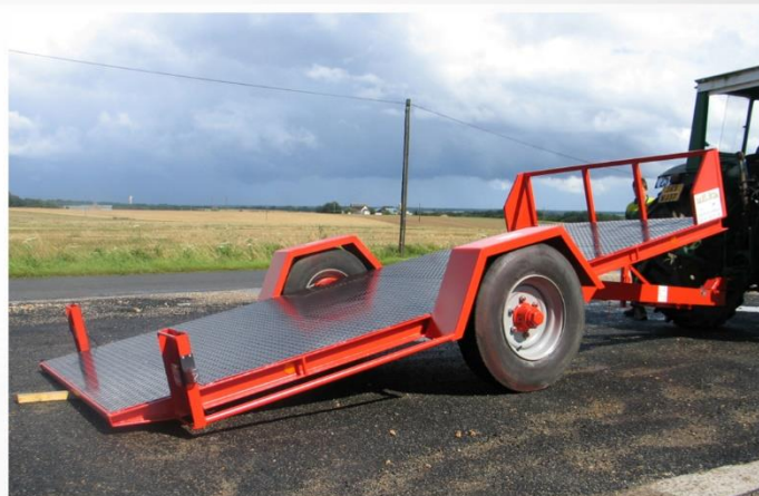
Surface utile : 4m00 x 2m04, Plateau basculant hydraulique, Essieu fixe, RC 215/75 R17.5
