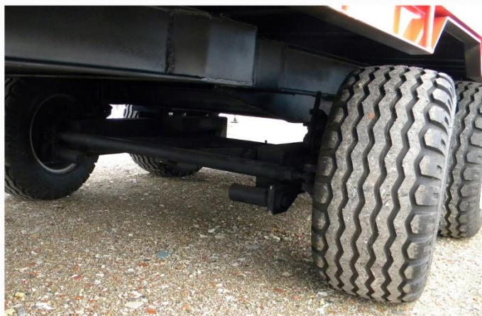
Surface utile : 7m00 x 2m54, Balancier SUIVEUR, RC 15.0-55 /17, Flèche décalée, Rampes doubles
