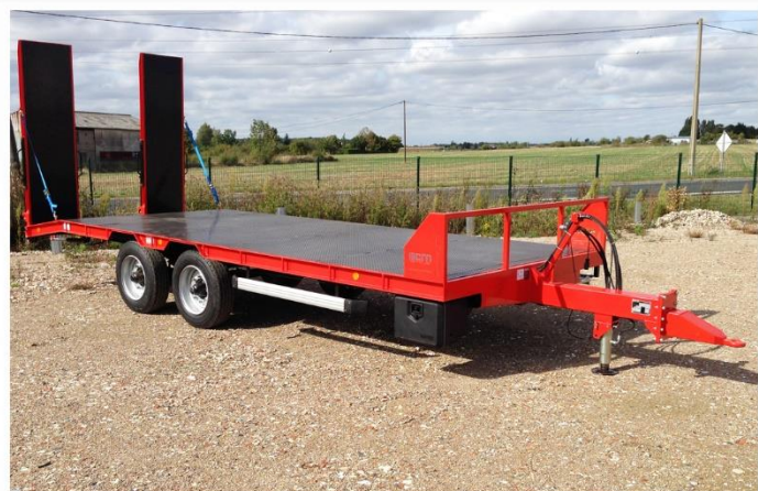
Surface utile : 7m00 x 2m54, Balancier, RC 245/70 R19.5, Flèche réglable
