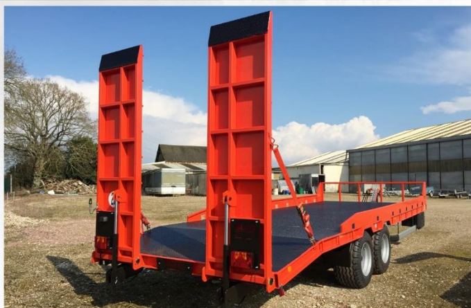
Surface utile : 7m00 x 2m54, Essieux fixes, RC 15.0-55 /17, Ridelles fixes 20cm
