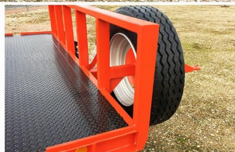
Dim. : 7m00 x 2m54, Tandem Colaert, RC 245/70 R19.5 + RS, Fer plat sur rive, Anneaux 3T, signalisation LED...
