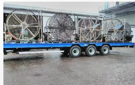
Dim. : 11m50 x 2m54, Suiv. Arrière, RS 385/55 R22.5 RCH, Anneau Tournant à boulonner, profil d'arrêt sur rive...
