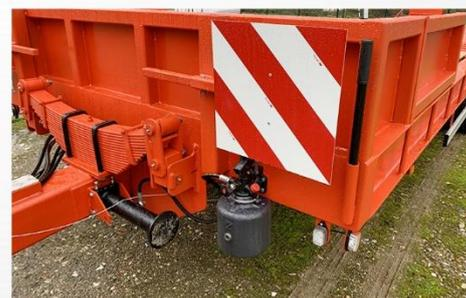
Dim. : 10m00 x 2m54, Suiv. Arrière, RJ 255/75 R17.5, Anneau Tourmant à boulonner, Béquilles hydro. arr. avec contrôle...
