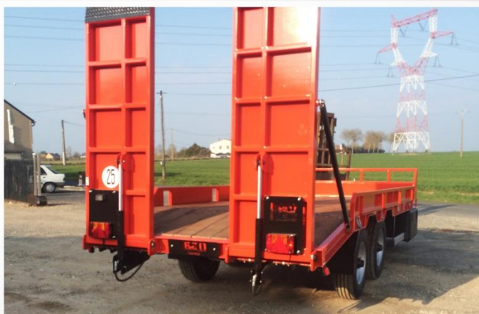
Surface utile : 5m50 x 2m54, Balancier, RC 235/75 R17.5 GoodYear, Anneau à boulonner réglable ...
