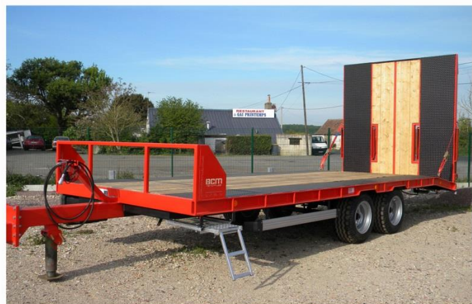
Surface utile : 6m60 x 2m54, RC 13.0-55 /17, Flèche réglable, Plate-forme mixte, Rampe largeur totale
