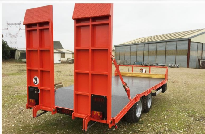
Surface utile : 5m00 x 2m30, Essieux fixes, RC 13.0-55 /16, Rampes larges (0m80), Bastaing avant
