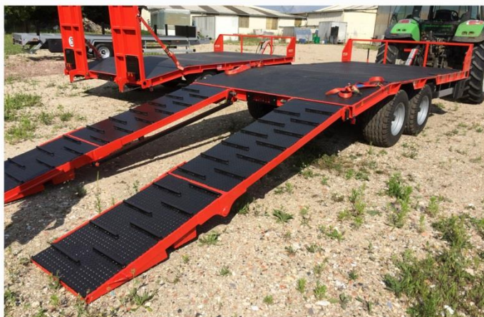
Surface utile : 5m00 x 2m54, Balancier, RC 15.0-55 /17, Rampes doubles et plancher fer + carré 20*20
