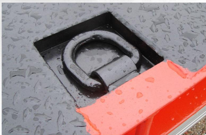
Surface utile : 5m00 x 2m54, Essieux fixes, RC 13.0-55 /17, Anneaux d'arrimages encastrés
