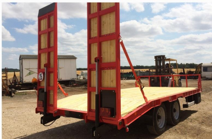
Surface utile : 5m00 x 2m54, Essieux fixes, RC 215/75 R17.5, Plate-forme Bois sapin
