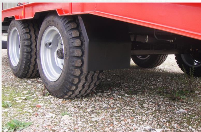
Surface utile : 5m00 x 2m54, Essieux fixes, RC 13.0-55 /17, Roue de secours & support
