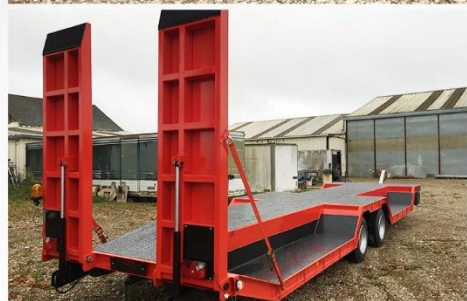
Surface utile : 10m00 x 2m54, RC 215/75 R17.5 Jum., Plate-forme Fosses et résa. sur châssis
