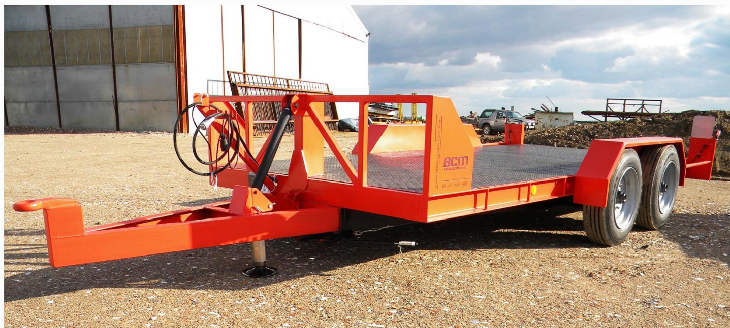
Surface utile : 5m00 x 2m04, Essieux fixes, RC 215/75 R17.5, Rampes & Béquilles arrières manuelles
