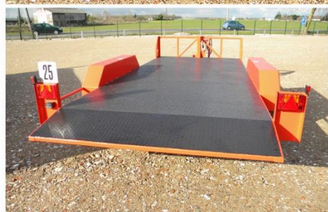
Surface utile : 5m00 x 2m04, RC 215/75 R17.5, Plateau Basculant hydraulique, Treuil électrique 7T
