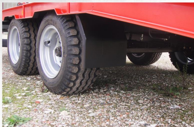
Surface utile : 5m00 x 2m54, Essieux fixes, RC 13.0-55 /17, Roue de secours & support
