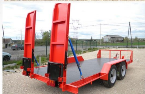
Surface utile : 5m00 x 2m04, Essieux fixes, RC 215/75 R17.5, Rampes & Béquilles arrières manuelles
