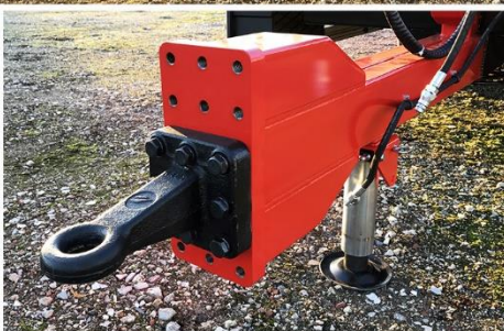
Dim. : 5m00 x 2m30, Balancier, RC 15.0-55 R17, Anneau à boulonner & réglable, Rampes doubles, Pompe à main...
