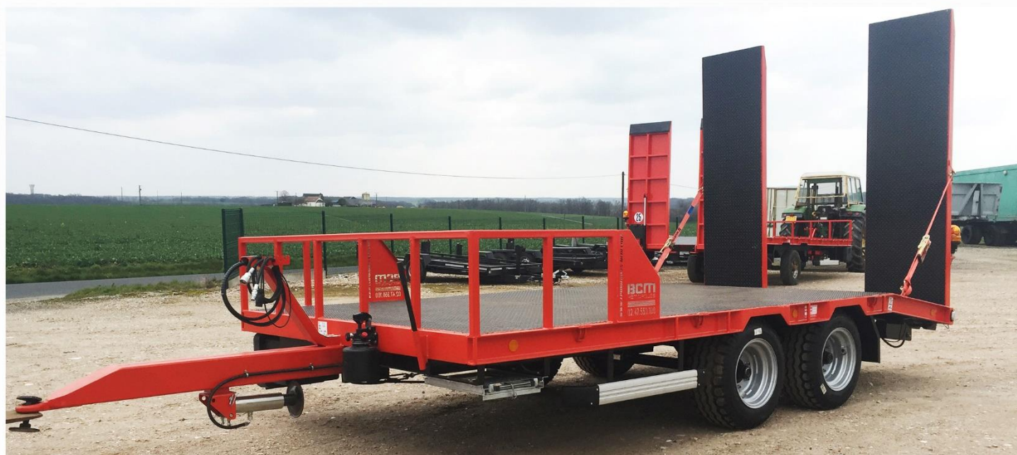
Dim. : 5m00 x 2m54, Rampes plancher Bois Guide Chenille, Béquille latérale & Pompe à main, Fer plat sur rive...
